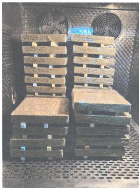
Рисунок 4 – Дослідні зразки, які піддають циклічному температурному впливу
