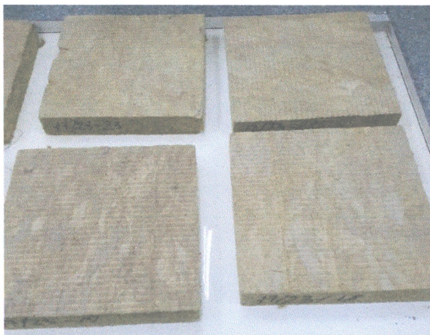
Рисунок 11 – Зволоження дослідних зразків № 17/23 теплоізоляційного матеріалу марки «ТЕХНОФАС ОПТИМА»
